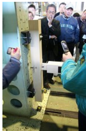
道産トドマツ材による長ぼぞ込栓打ちの耐力実験
