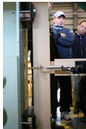
道産トドマツ材による長ぼぞ込栓打ちの耐力実験
