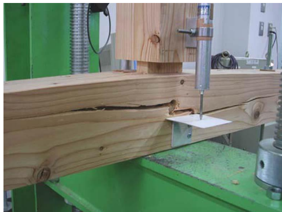
道産カラマツ材による長ホゾ込み栓打ちの耐力実験
